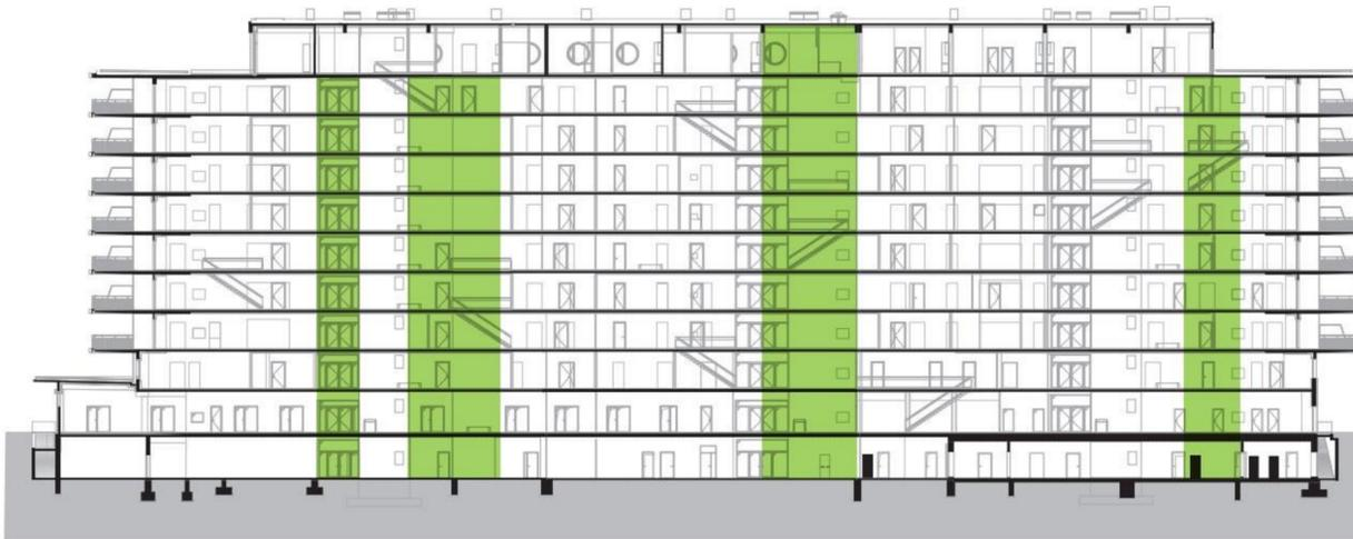
Schnitt mit durchlaufenden Betonwandscheiben in Längsrichtung | *Coupe longitudinale des refends continus en béton*
